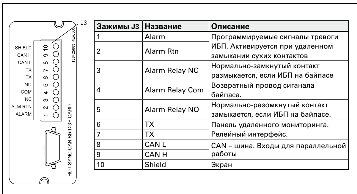
Рисунок 22 Адаптер XSlot Hot Sync и контактный интерфейс
